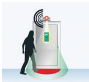
Predalarm 2: optični/zvočni alarm z dodatno razsvetljavo
